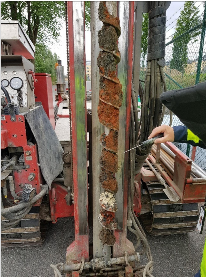
Figur 9 Provpunkt NC1809 med tydliga rester av tegel, och längre ner ett gulvitt okänt material.
